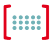
DALLES PODOTACTILE SIGNALANT L'APPROCHE DU QUAI
